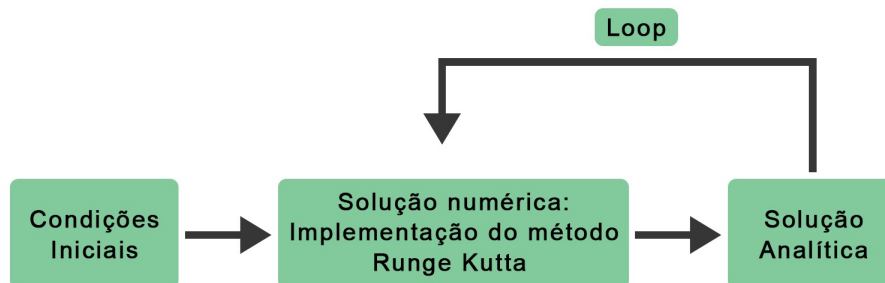
Figura 5.3: Fluxograma implementado para resolver as equações de Bloch ópticas. Durante a solução numérica, as populações atômicas são excitadas pelo pulso e na solução analítica ocorre o decaimento espontâneo das populações.
